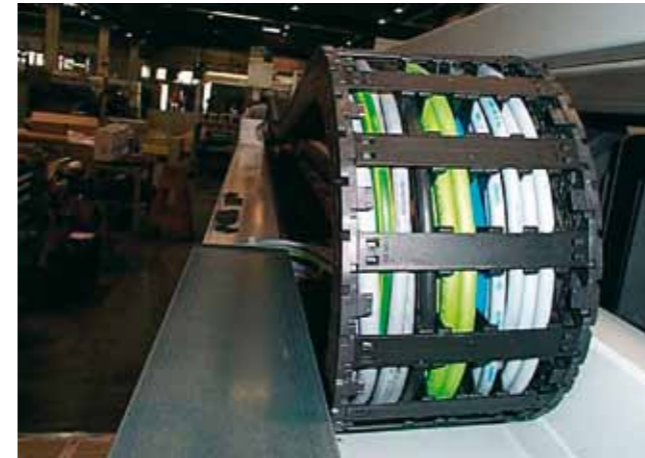
Abriebarm dank aufeinander abgestimmter Kunst- stoffe Abrasion-free due to special materials
