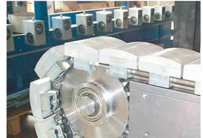
Förderkette für Güter mit empfindlichen Ober- flächen mit drylin® W Chain for sensitive surfaces with drylin® W linear guide system
