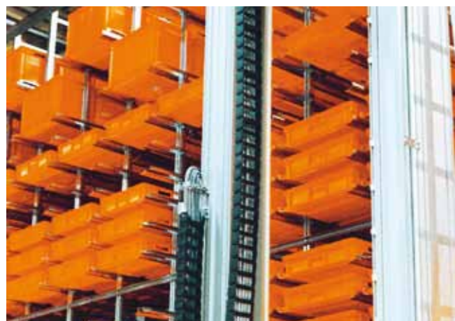
e.ketten® mittlerer Größe an Regalbediengeräten e.chains® in medium size in storage and retrieval machines
