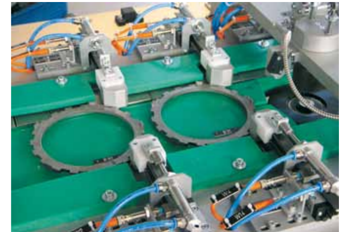
drylin®-Prüfstation für Wirbelstromrissprüfung in der Automobilindustrie drylin® test station for the eddy- current crack test of components for the automobile industry
