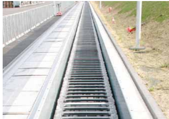
P4.56: Dauertest im igus®-Außenversuch - Verfah- rung 120 m P4.56: igus® outdoor test set up - travel length 120 m
