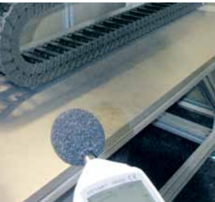
Geräuschprüfung in eigener Schallkabine Noise level test inside an igus® acoustic cell
